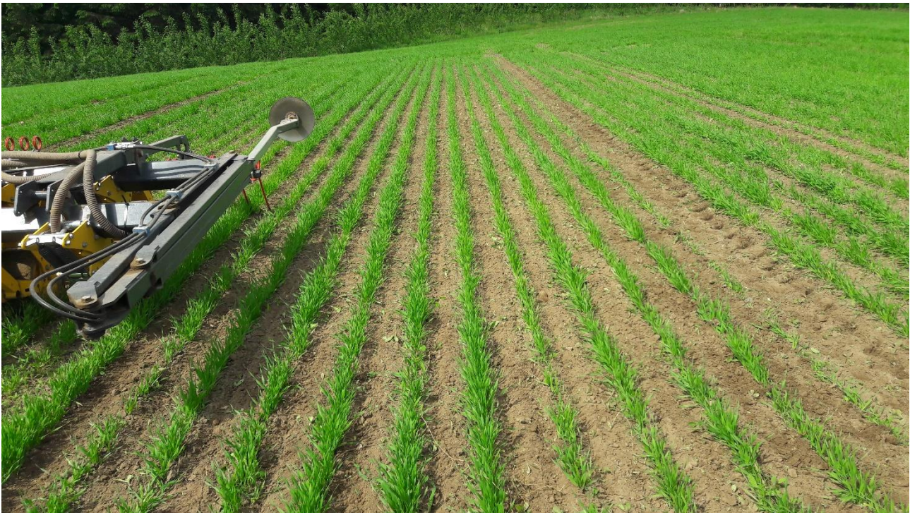
Foto 4: Radrensning kan være et godt supplement i ukrudtsbekæmpelsen. Særligt ved en høj forekomst af aggressive ukrudtsarter kan radrensning være lønsomt. Fotograf: Lars Egelund Olsen, SEGES Økologi Innovation
